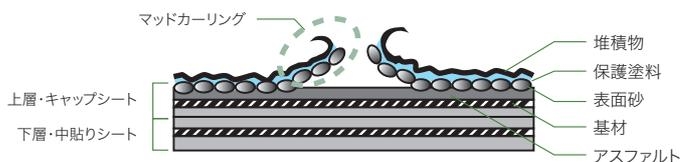
マッドカーリング現象(アスファルト露出防水層断面イメージ)
