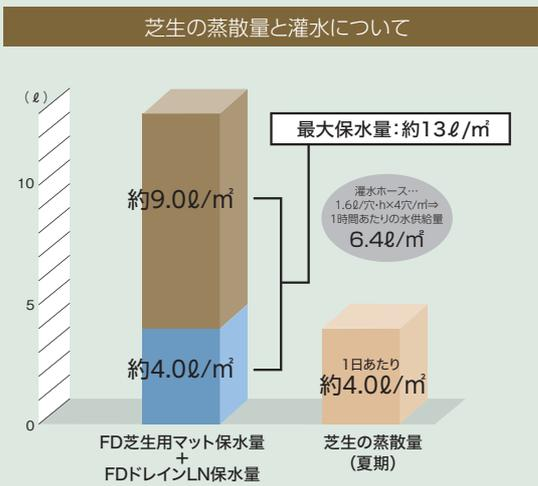
上記の計算よりFD-LSシステム芝生の生育に必要な保水量を有していることがわかります。しかし、乾燥した日が続いた場合には手で灌水を行い調整してください。
