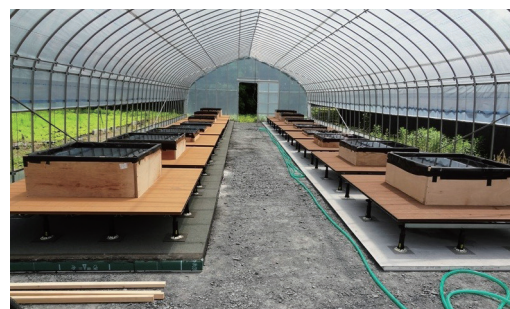
降雨などの影響で、荷重が変わらないよう温室内に試験体を設置
